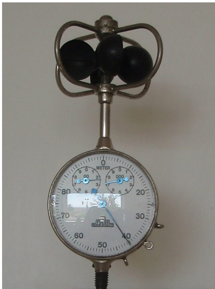
Malý přístroj na měření rychlosti větru. Cimrman jej používal též k měření kvality pěvců do svých operet.
